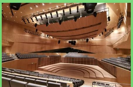
天津茱莉亚学院项目距拟建Z3号地铁线距离不足10m，其建筑声学效果要求及高，项目建筑设计室内允许噪声级 $\leq 15\text{dB}$ ，目前国内同类建筑最高标准为 $20\text{dB}$ ，如此高的要求为国内首例。为了降低周边地铁、车辆等震动带来的噪声影响，演奏厅和音乐厅采用房中房隔振结构，上部主体结构采用屈曲约束支撑和调频阻尼器进行消能减震。主要功能建筑设置浮筑地板，减振隔振吊顶，GRG墙面。所有机电设备及材料均以满足声学要求为主。
